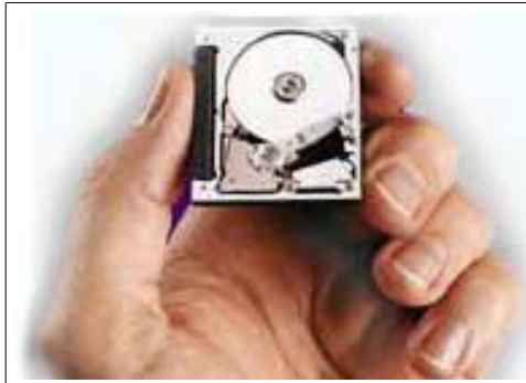
Hitachi Microdrive, un gioiello di ingegneria, entra nello slot delle CF-II.
