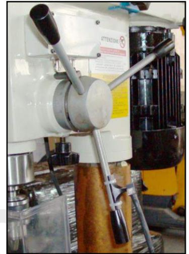
Figura 26 – Montaggio aste.
