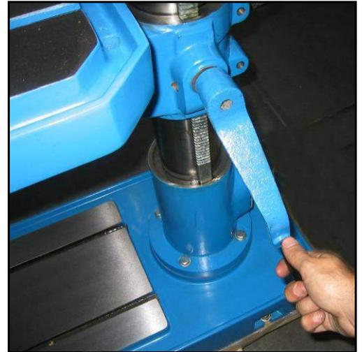
Figura 15 – Sbloccaggio vite.
