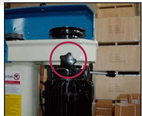
Figura 8 – Manopola di bloccaggio motore.
