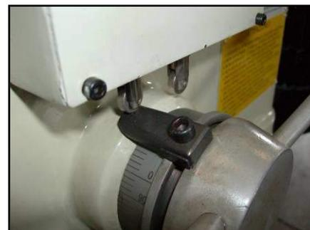
Figura 30 Ghiera graduata e fine corsa.
