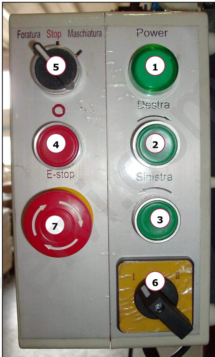
Figura 6 – Quadro comando della macchina.
