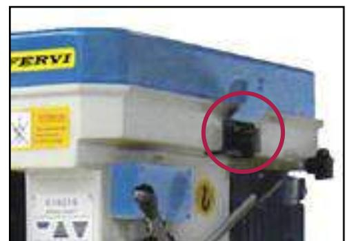
Figura 9 – Manopola bloccaggio puleggia.
