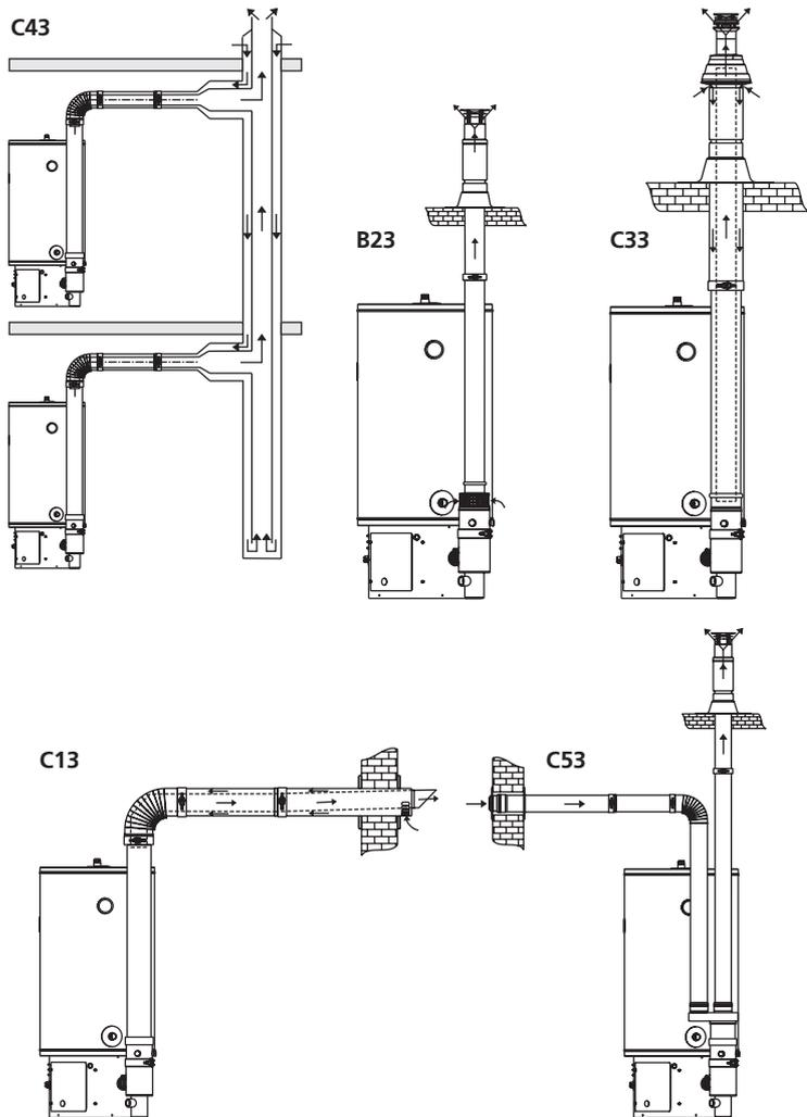
Per informazioni dettagliate sul materiale per l'evacuazione dei fumi, leggere il Manuale di installazione e messa in esercizio.
