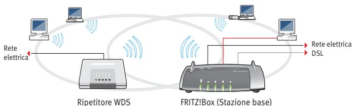
WDS – ampliamento della portata WLAN con l'ausilio di un ripetitore WDS
