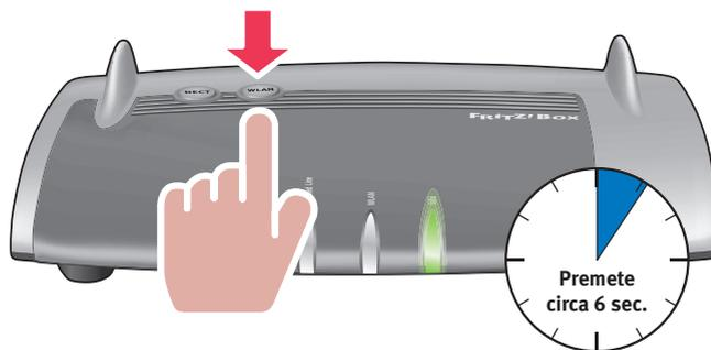
2. Non appena il LED “WLAN” inizia a lampeggiare, attivate la funzione WPS dell’apparecchio WLAN con un interruttore WLAN o nel software di controllo, a seconda dell’apparecchio. L’attivazione va avviata entro 2 minuti.
