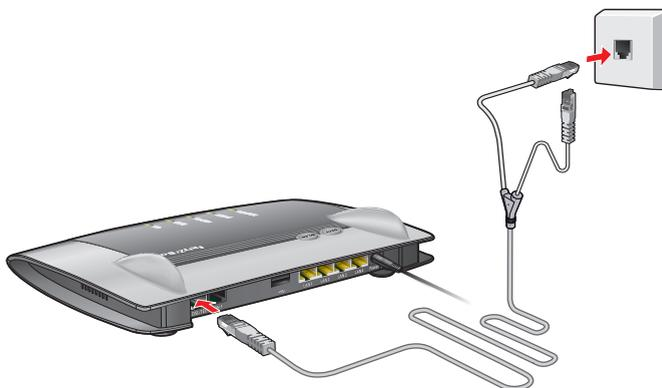
Collegamento con cavo DSL/telefono e adattatore DSL
