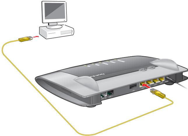
Collegamento di un computer con un cavo di rete FRITZ!Box
