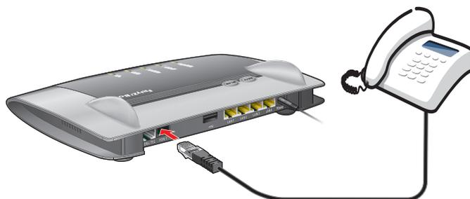
Collegamento di un telefono analogico con connettore RJ11
