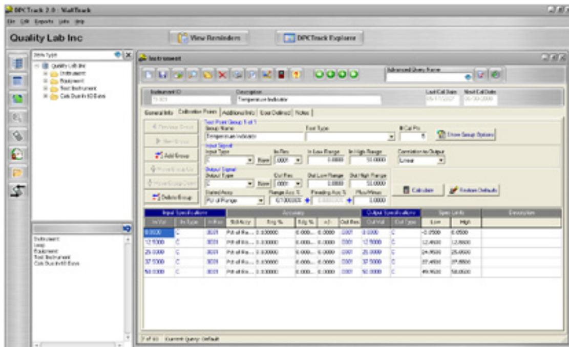
Il software 750SW DPC/TRACK 2 ha una base dati di strumentazione che facilita la gestione della strumentazione, consente di creare e pianificare i test, di caricare e scaricare lo strumento 753 o 754, di stampare una vasta gamma di report standard e di gestire i dati di calibrazione.
