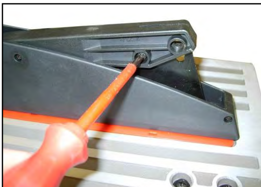
Figura 33 – Rimozione del riparo e dell'inserto.
