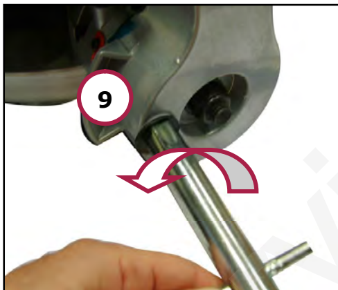
Figura 22 – Regolazione dell'inclinazione in posizioni fisse.
