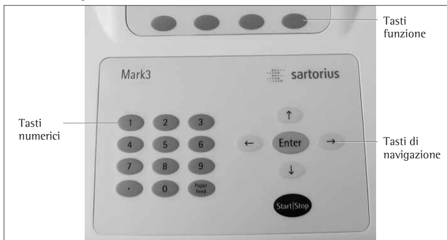
Il pannello dei tasti dell'analizzatore d'umidità LMA100P
