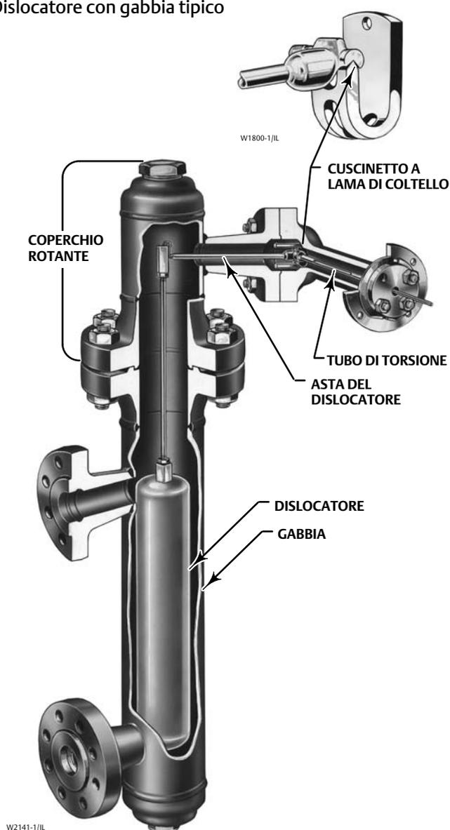
L'estremità libera del tubo è sigillata da una guarnizione ed è fissata rigidamente al braccio del tubo di torsione, consentendo all'estremità sporgente dell'albero di girare e quindi di trasmettere un movimento rotatorio. In questo modo l'interno del tubo di torsione rimane alla pressione atmosferica, eliminando la necessità di una baderna e gli svantaggi procurati dalla frizione delle baderne.
