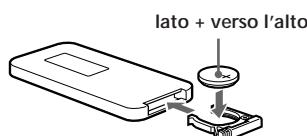
Sostituire le batterie con batterie al litio CR2025 Sony o Duracell DL-2025. L'uso di altre batterie potrebbe causare incendi o esplosioni.
