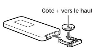
Remplacez la pile par une pile au lithium Sony CR2025 ou Duracell DL-2025. L'utilisation d'une pile d'un autre type peut présenter un risque d'incendie ou d'explosion.
