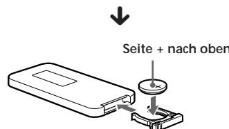
Tauschen Sie eine alte Batterie gegen eine Lithiumbatterie CR2025 von Sony oder eine DL-2025 von Duracell aus. Verwenden Sie keine anderen Batterien. In diesem Falle bestünde Feuer- oder Explosionsgefahr.
