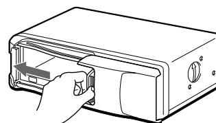
Utilizzare il contenitore dischi in dotazione o il contenitore dischi XA-250. Il contenitore dischi XA-10B non può essere utilizzato con questo apparecchio. Se si utilizza qualsiasi altro contenitore, potrebbero sorgere problemi di funzionamento.
