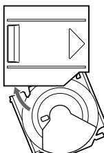
Con la parte tagliata del vassoio rivolta verso di voi, inserire il lato destro del vassoio nell'alloggiamento, quindi inserire l'angolo sinistro fino a che non fa clic.
