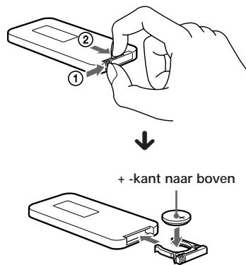
Vervang de batterij door een Sony CR2025 of een Duracell DL-2025 lithiumbatterij. Het gebruik van andere batterijen kan leiden tot brand- of explosiegevaar.
