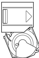
Hierbei muß die Aussparung des Fachs auf Sie weisen. Setzen Sie dann die rechte Ecke des Fachs in den Einschub ein, und drücken Sie danach die linke Ecke an, bis das Fach mit einem Klicken einrastet.
