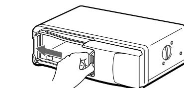
Gebruik het meegeleverde disc-magazijn of het disc-magazijn XA-250. Het disc-magazijn XA-10B kan niet met dit toestel worden gebruikt. Het gebruik van een ander magazijn kan defecten veroorzaken.
