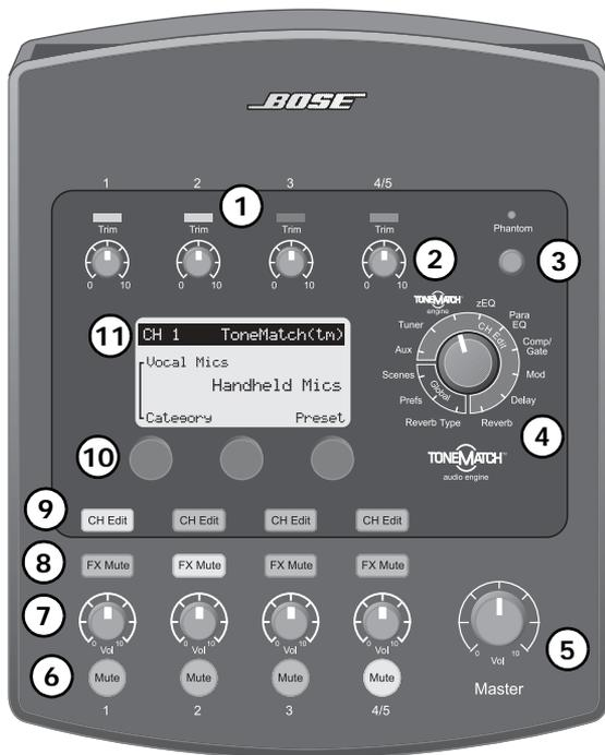
1. **LED di ingresso SIGNAL/CLIP (1-4/5)** – Mostrano lo stato del segnale degli ingressi in base al colore: verde indica la presenza di un segnale di ingresso, giallo indica un segnale prossimo alla distorsione (clipping) e rosso indica una condizione di clipping.
