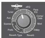
La funzione ToneMatch™ engine consente di selezionare una preselezione ToneMatch per lo strumento o il microfono desiderato. Questa tecnologia proprietaria ottimizza l'equalizzazione del sistema per preservare il suono naturale di uno specifico strumento o microfono. Le preselezioni sono organizzate in categorie e vengono selezionate indipendentemente per ogni canale.
