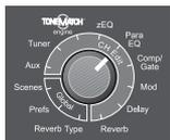
La funzione Para EQ fornisce l'equalizzazione parametrica centrata su una frequenza specificata dall'utente entro la gamma da 50 Hz a 8000 Hz.
