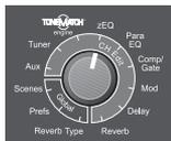
La funzione zEQ fa parte della tecnologia delle preselezioni ToneMatch™. Consente di regolare le frequenze bassa/media/alta comprese nella gamma dello strumento o del microfono.
