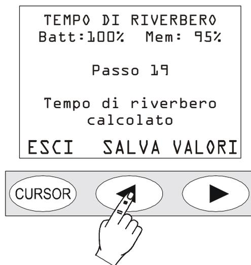
**Per ripristinare il normale funzionamento del fonometro ed uscire definitivamente dal programma di misura del tempo di riverbero, spegnere lo strumento (tasto ON/OFF) e riaccenderlo.**
