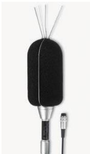
L'unità microfonica HD.WME950N è adatta a rilievi prolungati nel tempo in ambiente esterno, anche in postazione fissa non presidiata. L'unità è adeguatamente protetta dalla pioggia e dal vento; il preamplificatore riscaldato, assieme allo strato protettivo della membrana della capsula microfonica, forniscono stabilità dei parametri acustici nel tempo e permettono di effettuare rilievi in un ampio intervallo di condizioni ambientali.
