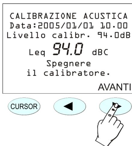
5. Di seguito alla calibrazione acustica viene avviata automaticamente la **calibrazione elettrica**. Questa parte della procedura genera i dati di riferimento per le calibrazioni elettriche successive.
