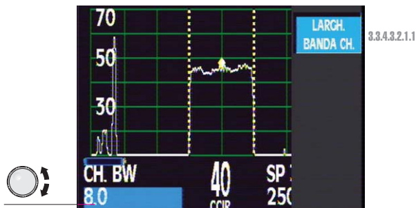
Figura 125.- Larghezza di banda del canale digitale
