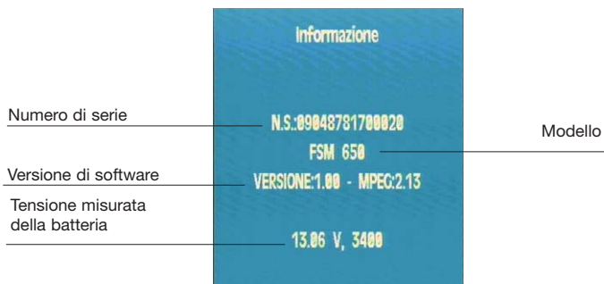
Figura 53.- Finestra Informazioni strumento
