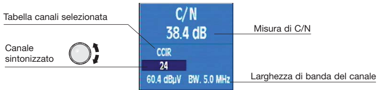
Figura 71.- Misura C/N automática. Sintonia per canale
