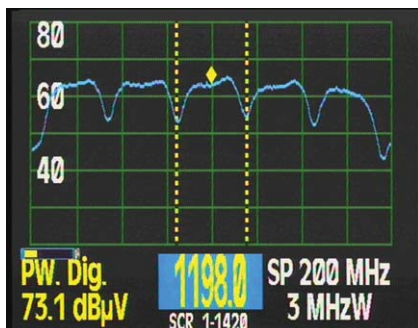
Figura 14.- Canale SCR sintonizzato
