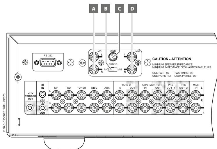
**A INGRESSO MC:** ingresso per testina di pick-up Bobina mobile. Collegare i doppio cavo RCA dal giradischi a questa entrata se si usa testina a Bobina mobile.
