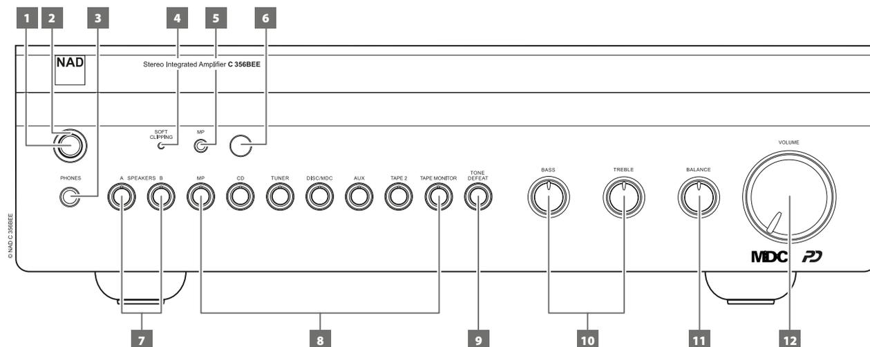
**1 TASTO STANDBY:** con l'interruttore di alimentazione del pannello posteriore impostato sulla posizione di accensione, premere questo tasto per accendere C 356BEE dalla modalità Standby. Il LED di Standby passa dal colore ambrato a blu. Premere di nuovo il tasto STANDBY per riportare l'unità in modalità Standby.
