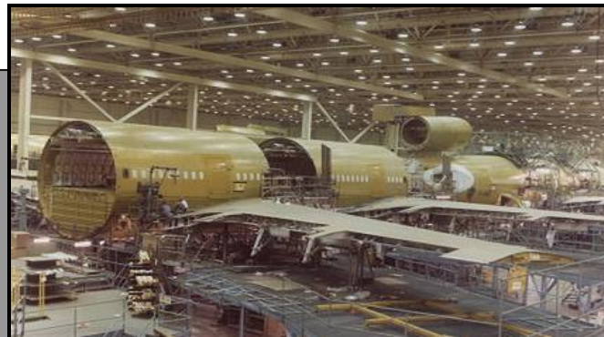
L'ala è assemblata alla fusoliera
