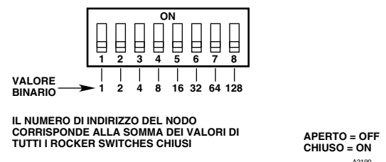
Figura 16: Interruttori di indirizzo per X2200
