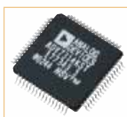
Convertitore D/A Video a 216 MHz/ 14-Bit (DV-868AVi-S)
