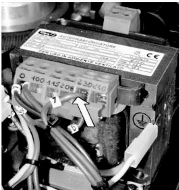
4) Se la tensione da voi settata è 100 o 115V sostituite il fusibile da 3 Amps T, adatto alla selezione 208/230/245 V, con uno da 5 Amps T nel portafusibile sulla base del proiettore e viceversa. I fusibile è in una busta isolante all'interno della confezione del presente manuale di istruzioni.
