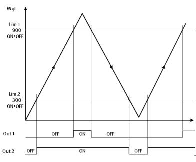
Se i limiti (Lim) per 'On' e 'Off' sono uguali, si attiva (On) l'uscita 1 (Out 1) se il peso (Wgt) supera il valore, e si disattiva (Off) l'uscita 2 (Out 2) se il peso scende sotto il valore.
