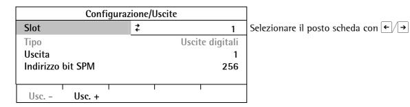
La selezione dell'uscita è possibile con [Usc. -] / [Usc. +] oppure con l'immissione del numero. Se lo slot selezionato non ha delle uscite, sul display appare:
