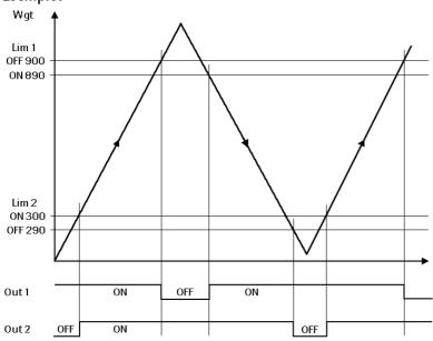
Il segnale di uscita (Out 1) del limite 1 (Lim 1) si disattiva (Off) sopra il peso (Wgt) di 900 kg; il limite 2 (Lim 2) si disattiva (Off) sotto il peso di 290 kg. Entrambi i limiti hanno un'isteresi di 10 kg. In caso di caduta di tensione entrambe le uscite commutano su 'Off' e indicano contemporaneamente il riempimento insufficiente ed eccessivo.
