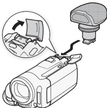
Potete anche utilizzare microfoni disponibili in commercio. Collegate il microfono esterno al terminale MIC. Utilizzate microfoni a condensatore disponibili in commercio con la relativa alimentazione e un cavo di lunghezza non superiore ai 3 m. Potete collegare quasi tutti i microfoni stereo con spinotto di diametro  $\varnothing$  3,5 mm ma i livelli di registrazione audio possono variare.
