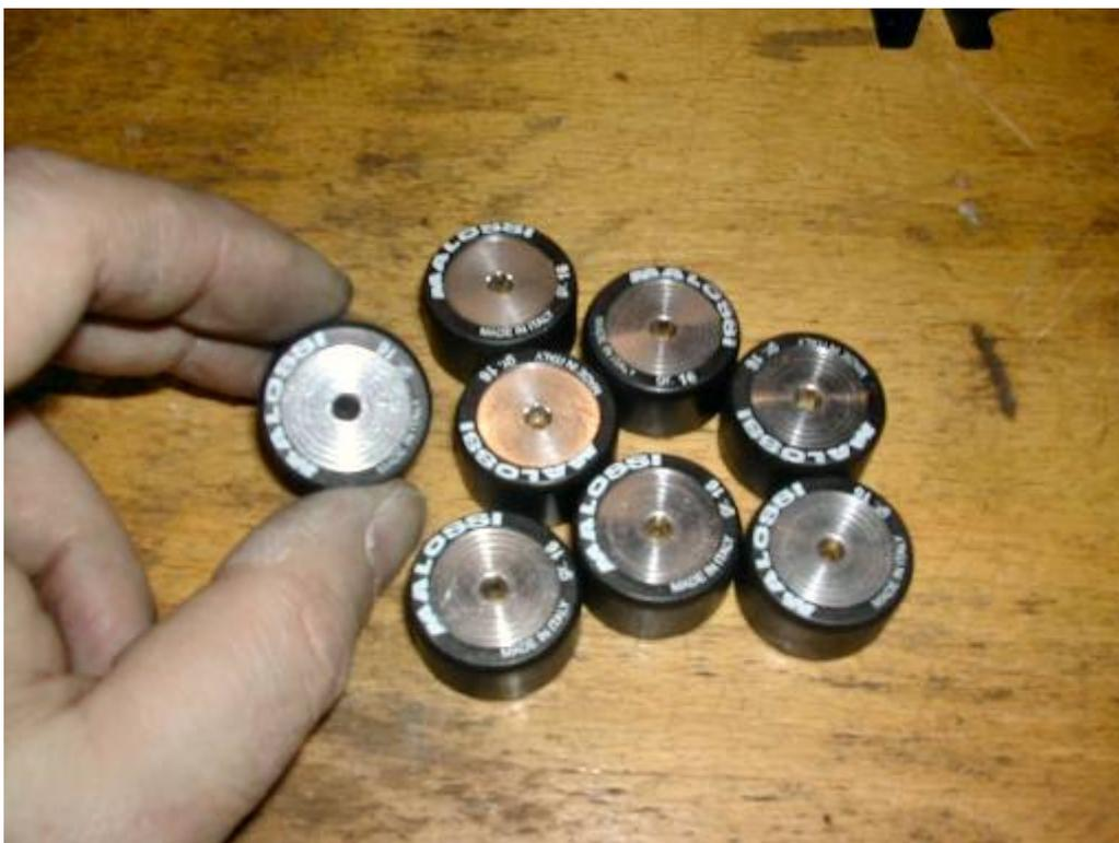
Qui sotto i diversi tipi di rulli: l'originale (1), poi quello da 16 gr (2). e infine quello da 15 gr (3). Osservate il foro al centro dei rulli MALOSSİ: in base al diametro dello stesso se ne determina la grammatura. L'interno del rullo originale è realizzato in ottone.
