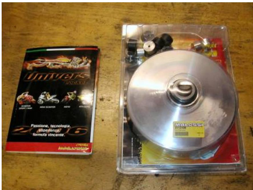
Nella foto sotto il contenuto della confezione: oltre alla semipuleggia scorrevole (2) ed il relativo distanziale (1) sono fornite due serie di rulli di diversa grammatura (3): da 15 gr. e da 16 gr., oltre alle relative boccole in teflon (4). Le stesse boccole recano stampati i dati inerenti il peso delle stesse una volta assemblate con le relative massette, (per non far confusione) ma sono assolutamente identiche.
