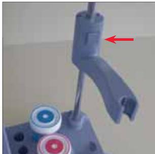
6. Installare il sensore sulla pinza porta elettrodi. Inserire il cavo sulla scanalatura.
