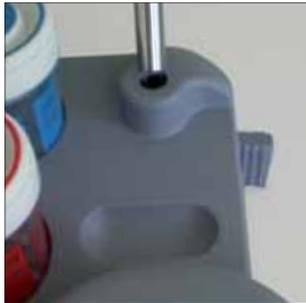
4. Girare la leva in senso antiorario fino a fissare perfettamente l'asta.
