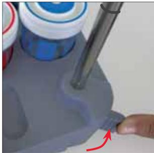
5. Montare la pinza porta elettrodi sull'asta premendo leggermente il pulsante.
