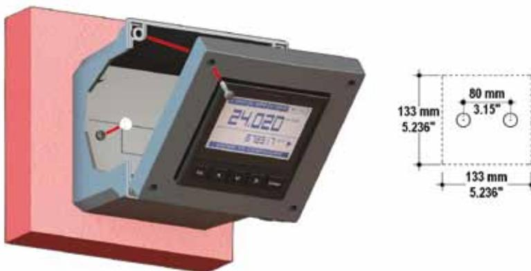
Stringere le viti frontali della cassetta e i passacavi impermeabili, inoltre internamente al box applicare i tappi sulle sedi delle viti per ottenere una installazione IP65.
