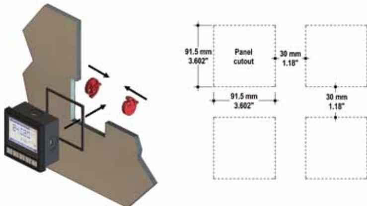
Fissare lo strumento sul pannello stringendo a mano le chiocciola di fissaggio (M9.SN1).
