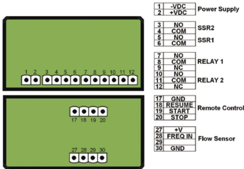
Per il cablaggio del sensore, fare riferimento al manuale dello stesso.
