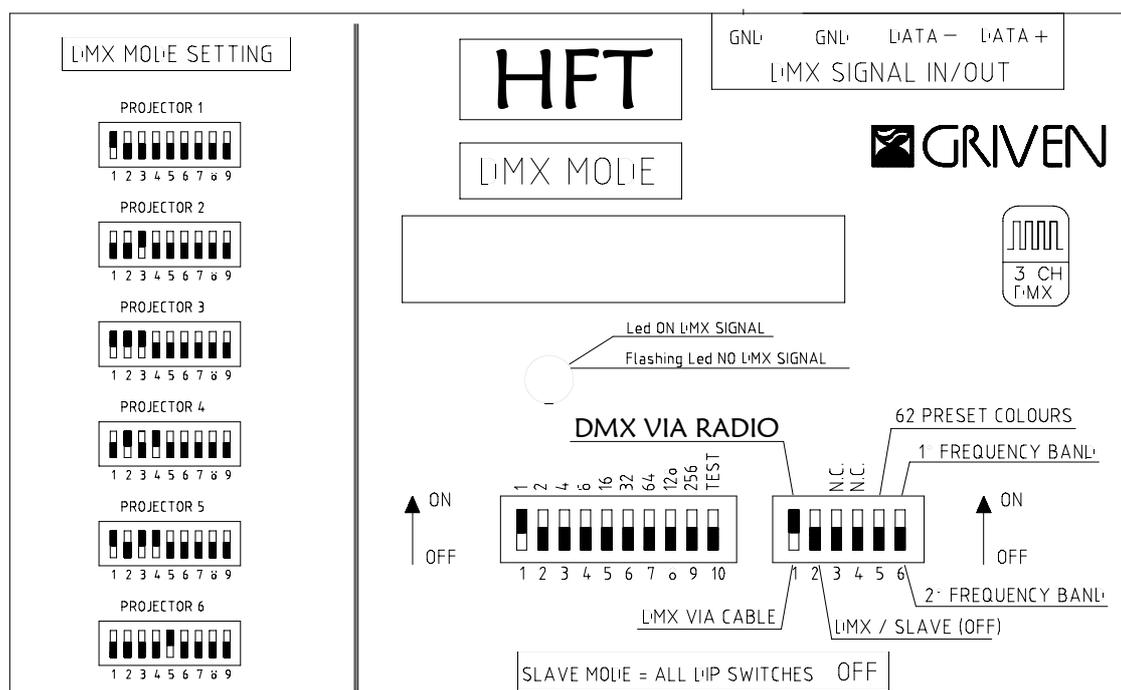
I dip switch assumono lo stesso significato che assumono durante il funzionamento in modo DMX/SLAVE (vedi paragrafo 4.4 Funzionamento in DMX/SLAVE) con la sola eccezione dei dip switch n°1 e n°6 del secondo gruppo:
