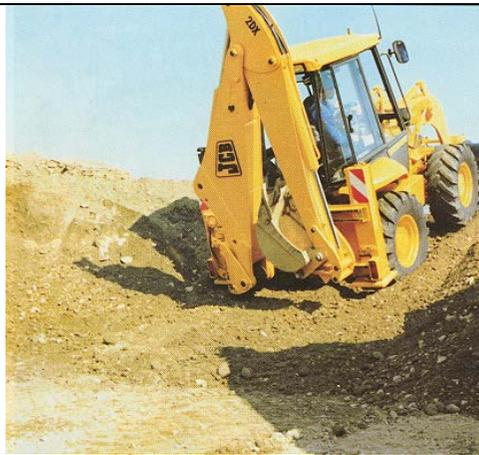
❑ In fase di carico del materiale su camion, assicurarsi che nel raggio di azione della macchina non ci siano persone; effettuare, quando possibile, il carico del camion dal lato di guida.
