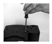
(5) Impostare i commutatori DIP-switch (nella parte posteriore della pompa) in base al numero che sarà assegnato alla pompa stessa. Nell'esempio riportato qui sotto, i DIP-switch sono impostati in modo che alla pompa sia assegnato il numero 1.
