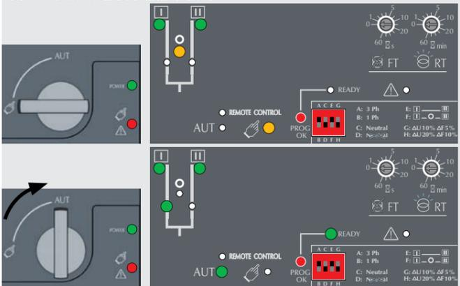
**AVVERTENZA** In base allo stato dell'ATyS t, l'automatismo può far spostare il dispositivo in un'altra posizione non appena il selettore commuta in posizione AUT. Si tratta del normale funzionamento del dispositivo.
