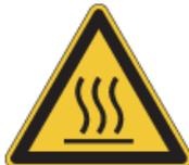
La resistenza di frenatura e altre parti metalliche possono riscaldarsi fino a temperature superiori a 70°C.
