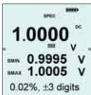
La funzione **SPEC** permette di visualizzare direttamente sullo schermo la tolleranza della misura in corso. In questo modo l'utente gestisce totalmente le incertezze di misura o precisioni in funzione delle portate o della frequenza del segnale alternato.
