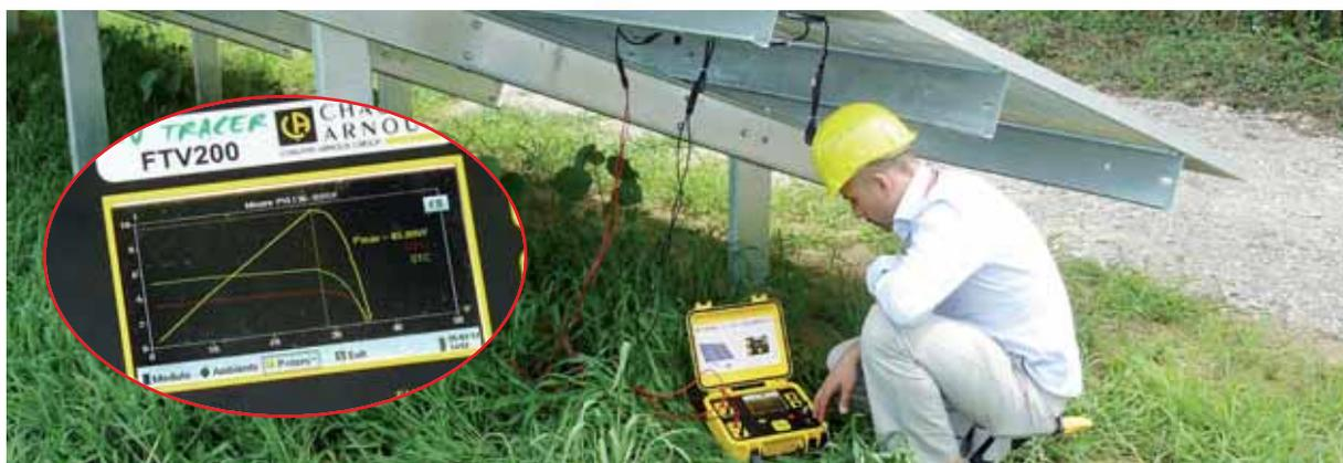
VERIFICATORE CARATTERISTICA I-V PANNELLI FOTOVOLTAICI
