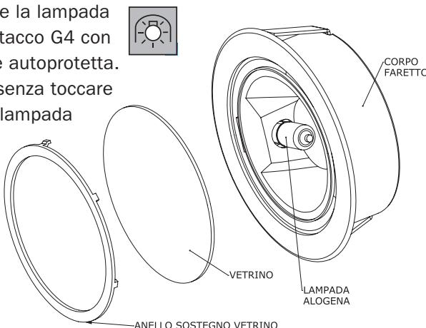
**PER SOSTITUIRE LAMPADA FARETTO ALOGENO QUADRO:**
