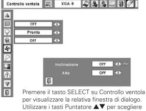
Utilizzare i tasti Puntatore ▲▼ per scegliere Inclinazione o Altitudine. Utilizzare i tasti Puntatore ◀▶ per passare da una opzione all'altra.
