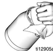
8. Rimuovere l'anello di tenuta, il cappello di polverizzazione e l'ugello del fluido. Pulire con solvente o acqua. Pulire la superficie della pistola con un panno inumidito in acqua o solvente.
