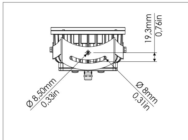
Utilizzare i fori Ø8.5 (1/4") e le asole sulla forcella per fissare l'apparecchiatura.
