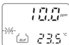
**Nota:** Se il valore della soluzione di calibrazione misurato dallo strumento è molto diverso da quello ideale, il simbolo "BUF" inizia a lampeggiare per indicare un errore nella procedura di calibrazione.
