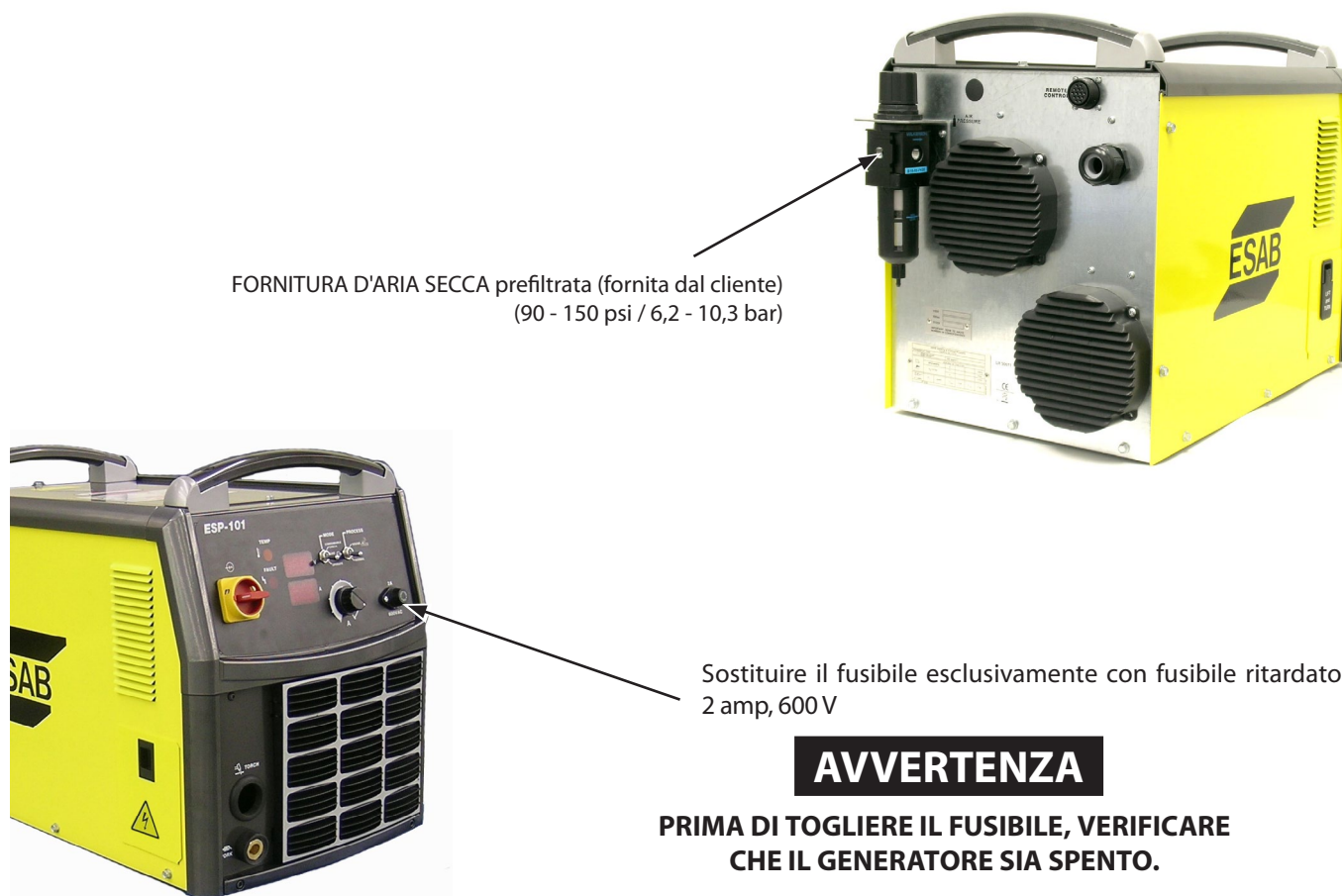
Figura 3-4. Connessioni di ingresso / Sostituzione di fusibili
