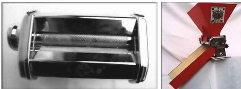
Si rimonta la macchina escludendo solo due lame che - nella parte inferiore - servono a ripulire i rulli dalla pasta. Si costruisce poi una tramoggia con del compensato da 5 mm, fissata al corpo macchina (ad esempio con due elastici ricavati da camere d'aria di bicicletta). Lo scivolo non è fissato, in quanto si appoggia nell'incavo sotto la testa della macchina e scende per gravità.
