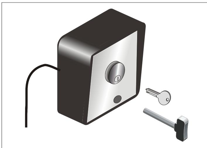
Inserire la chiave e girare verso destra o sinistra scoprendo il foro sotto la serratura. Inserire la chiave esagonale nel foro e girare in senso antiorario finché il motore non è completamente sbloccato.
