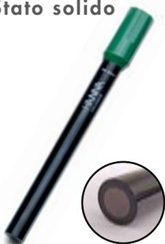
Gli **elettrodi a stato solido** sono disponibili sia come elettrodi a semicella, sia come elettrodi combinati (completi del sensore di riferimento). La superficie di rilevamento è realizzata in una sostanza solida omogenea di alogenuri d'argento o in materiale cristallino. HANNA produce sensori per la determinazione degli ioni bromuro, cloruro, ioduro, rameico, cianuro, fluoruro, piombo ed argento. Il corpo dell'elettrodo è costruito per durare a lungo.
