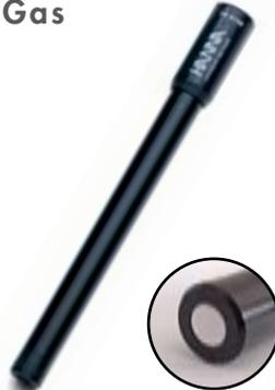
I **sensori a gas** sono elettrodi combinati in grado di rilevare i gas disciolti in una soluzione. L'elemento di rilevamento è separato dal campione da una membrana gas permeabile. HANNA produce l'elettrodo HI 4101 per l'ammoniaca e HI 4105 per l'anidride carbonica. Questo tipo di elettrodi non è disponibile come semicella.
