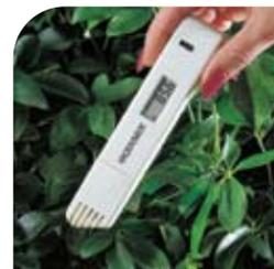
HYGROCHECK è un igrometro tascabile progettato per i controlli a campione di umidità relativa (U.R.). Lo strumento, in robusta plastica ABS, è dotato di display a cristalli liquidi che visualizza le misure. Le misure sono semplici da eseguire. È sufficiente accendere lo strumento, attendere alcuni secondi, e leggere la misura di umidità relativa percentuale, nella scala da 10 a 90%.
