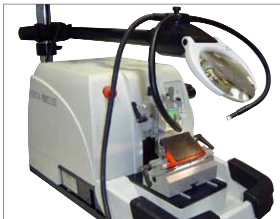
Fig. 70, Microtomo rotativo Leica con accessori opzionali montati: Lente d'ingrandimento e conduttore a fibre ottiche
