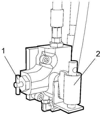
**Fig. Pompa per il rilascio del freno**
