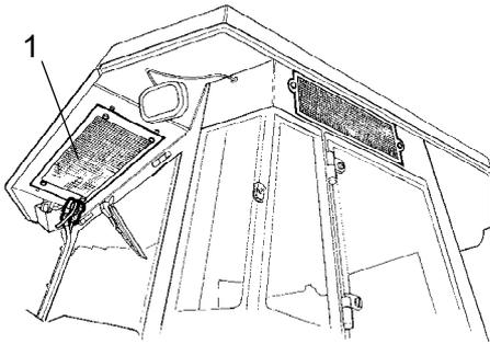
Quando la capacità di raffreddamento è marcatamente ridotta, pulire l'elemento del condensatore (1) posto sul bordo posteriore della cabina e pulire anche l'unità di raffreddamento della cabina. Vedere il capitolo "Ogni 2000 ore di esercizio": controllo dell'aria condizionata.
