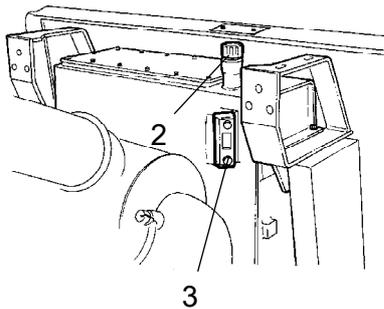
**Fig. Serbatoio idraulico**
