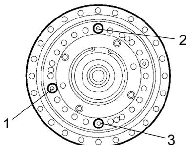
**Fig. Controllo del livello dell'olio nella scatola ingranaggi del tamburo**
