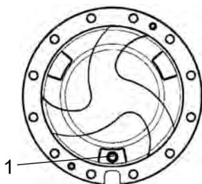
**Fig. Riduttore planetario/posizione di scarico**
