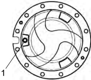
**Fig. Riduttore planetario/posizione di riempimento**
