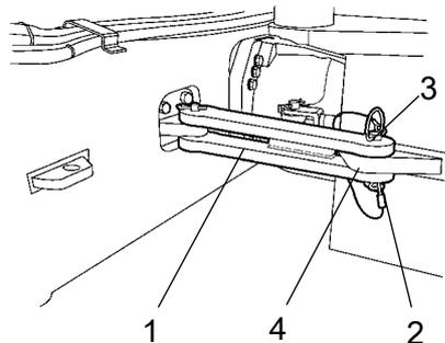
**Fig. Snodo in posizione di blocco**
