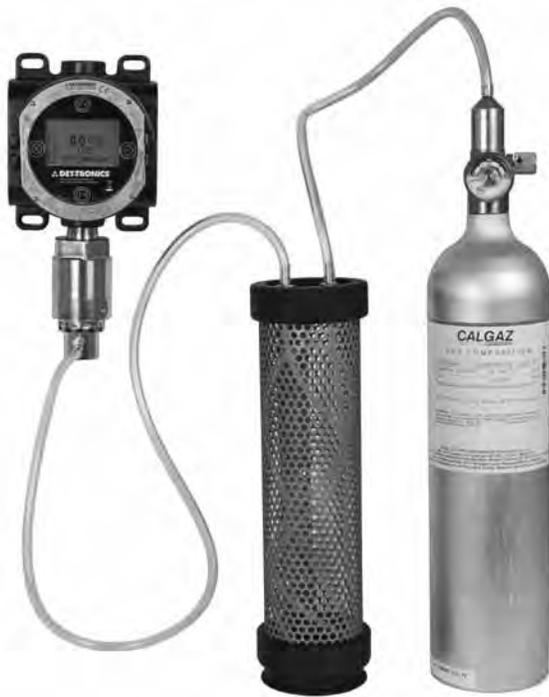
Kit di taratura con tubo di umidificazione collegato al sensore NTMOS
