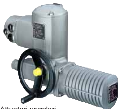
Attuatori angolari SG 05.1 - SG 12.1 Coppie disponibili da 100 a 1 200 Nm Tempi di manovra per 90° da 4 a 180 s
