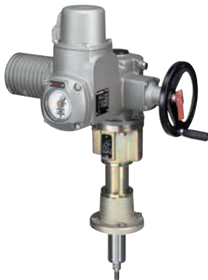
Dispositivi lineari di spinta LE con attuatori multigiro SA Spinte disponibili da 4 kN a 217 kN Corse disponibili fino a 500 mm Velocità di manovra disponibili da 20 a 360 mm/min
