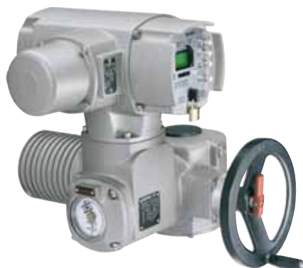
Unità di controllo AUMA Matic con attuatori multigiro SA/ SAR Coppie disponibili da 10 a 1 000 Nm Velocità disponibili da 4 a 180 min -1
