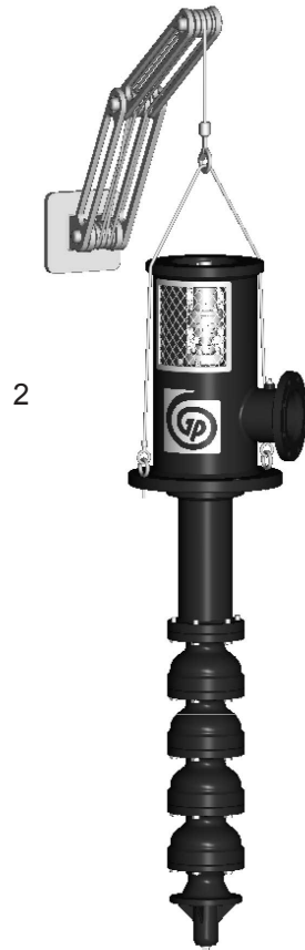
Figura 1: VIT sollevato da posizione orizzontale a verticale (per pompe fino a 15 piedi [4,6 metri] di lunghezza)
