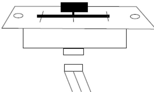
Il crossfader è sostituibile 'a caldo' (hot swappable); è quindi possibile sostituirlo in qualsiasi momento, anche quando l'apparecchiatura è sotto tensione. Sostituire soltanto con ricambio American Audio Feather Fader Plus. L'utilizzo di fader di qualsiasi altro modello può danneggiare gravemente l'apparecchiatura.
