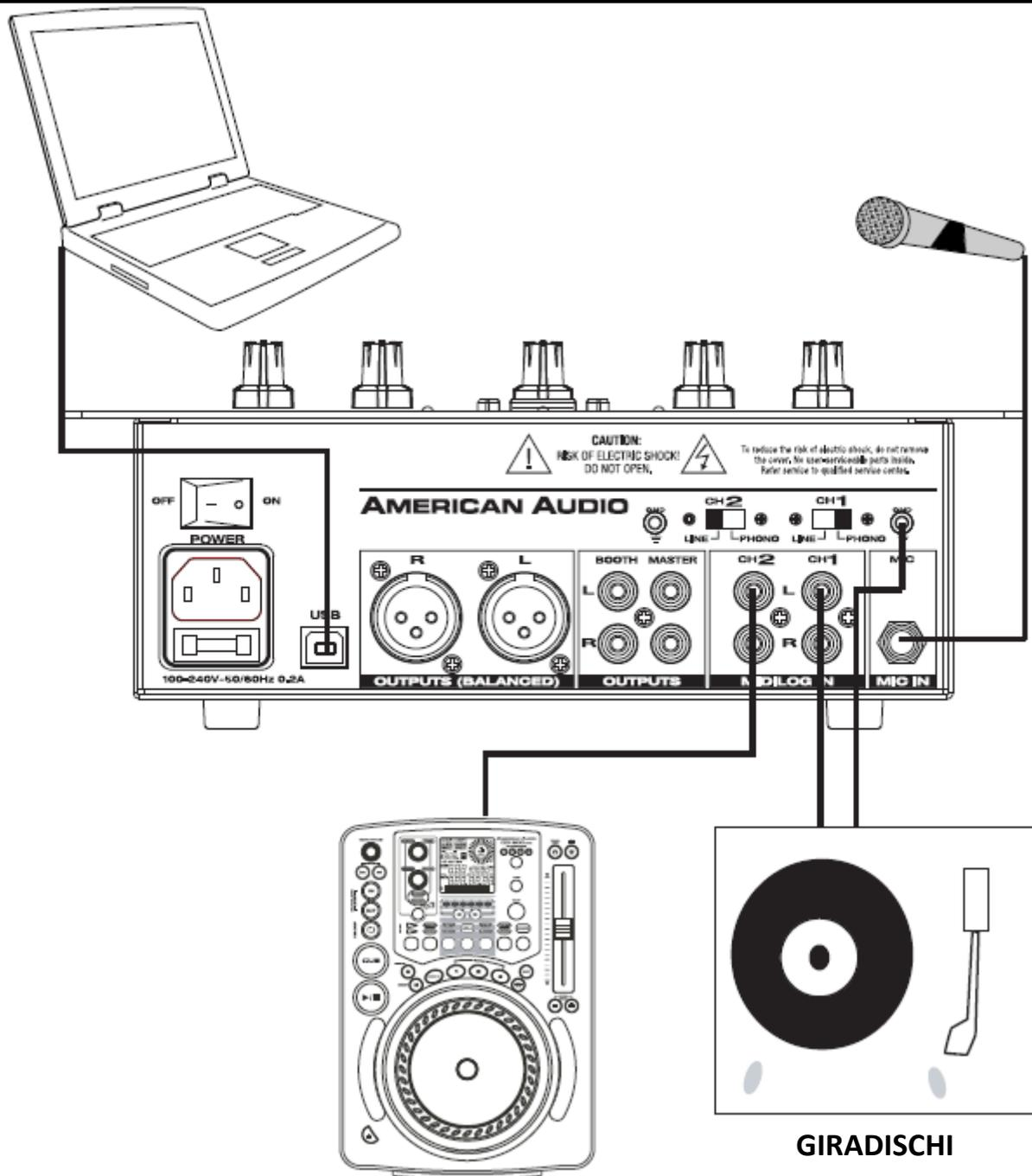
Questo schema mostra in dettaglio una tipica installazione per DJ completa di microfono, giradischi, lettori CD e piastra di registrazione.
