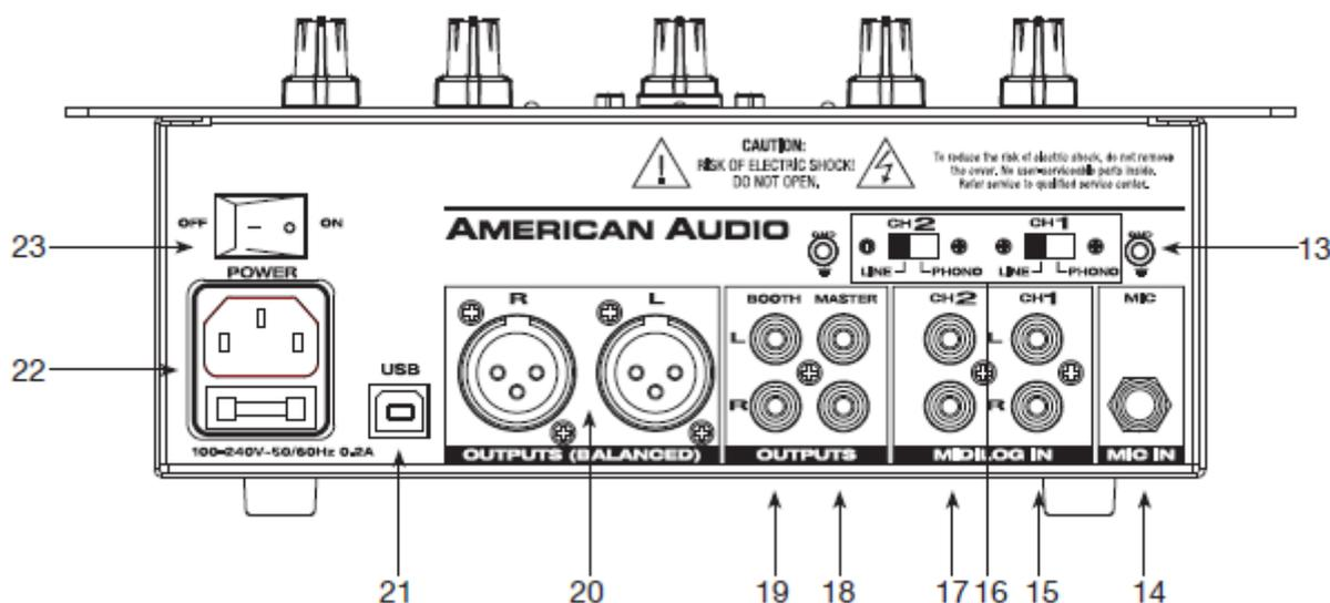
**13. GND (TERMINALE DI TERRA)** - Assicurarsi di collegare i cavi di terra del piatto giradischi ad uno o entrambi i terminali di terra disponibili, per ridurre i ronzii derivanti dalle testine magnetiche fonò.
