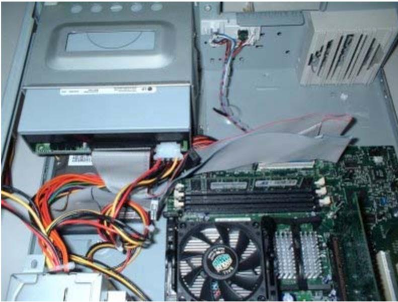
Inserimento delle schede PCI (*Peripheral Component Interconnect*), scheda di rete e scheda video. Maneggiare con cura queste schede ed evitare di strisciarle su superfici plastiche o vestiti, poichè potrebbero crearsi scariche elettrostatiche pericolose per i dispositivi elettronici.
