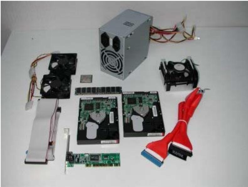
Nella figura sono rappresentati tutti gli elementi che inseriremo all'interno del *case*. Prima di iniziare il montaggio è bene fornirsi di viti e del materiale plastico, come nastri isolanti o fascette da elettricista utili per il fissaggio delle parti mobili e dei cavi.
