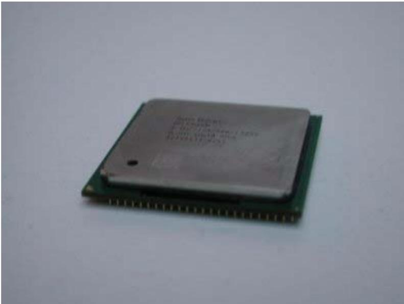
È importante assicurare un buon contatto tra il processore e il dissipatore di calore onde evitare surriscaldamenti eccessivi che potrebbero portare alla rottura del nucleo della CPU stessa. Le nuove generazioni di processori sono dotati di controlli e sensori di temperatura che ne inibiscono il funzionamento in casi critici.
