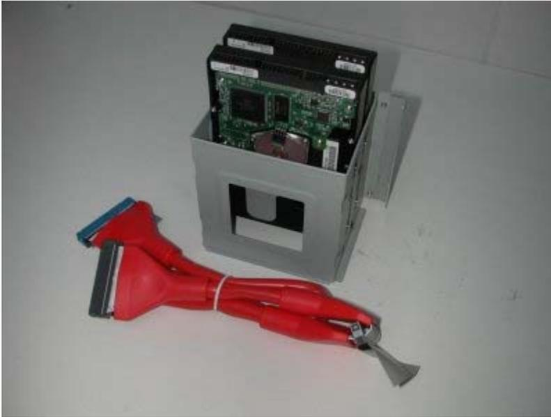
Inseriamo gli *hard disk* nel box metallico e li colleghiamo, insieme con il masterizzatore, all'alimentazione. Per quanto riguarda invece le piattine IDE, in previsione di un RAID *software* i due *hard disk* vanno collocati su due canali IDE differenti e configurati come *master*, questo per garantire una velocità di accesso maggiore. Il masterizzatore quindi possiamo inserirlo indifferentemente in uno dei due canali IDE come *slave*.
