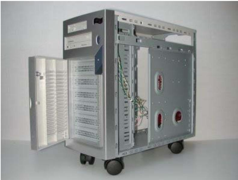
Lo *chassis* ospita due ventole aggiuntive per una dissipazione più rapida del calore. Alcune prove in laboratorio, hanno dato come risultato che la temperatura interna del *case* utilizzato risultata essere di 4/5 gradi inferiore a quella presente nei normali *case* privi di ventole. Una corretta ventilazione interna in un *server* è molto importante, in quanto il surriscaldamento dei componenti elettronici è tra le cause più frequenti di *crash* e di rotture.
