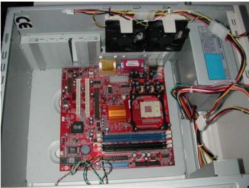
In basso, con il numero 6 sono indicati i due connettori IDE (*Integrated Drive Electronics*). Questi sono gli zoccoli in cui vanno inserite le piattine del *bus* IDE, per il collegamento degli *hard disk* e dei CD-ROM. L'inserimento corretto è indicato da una fessura sul lato lungo e da l'indicazione del piedino numero 1 corrispondente alla banda colorata lungo la piattina. Connettore per il *floppy*. Molto simile ai connettori IDE ma più piccolo e destinato alla piattina del
