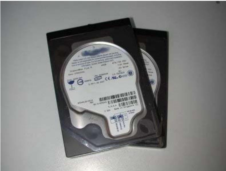
Gli *hard disk* scelti sono due da 40 *Gbyte*. Verranno configurati in RAID 1 (*mirroring*) e gestiti dal sistema operativo (RAID *software*), perciò la capacità totale risultante sarà di 40 *Gbyte*. Il RAID 1 è l'unico accorgimento adottato per la protezione dei dati sul nostro *server*.
