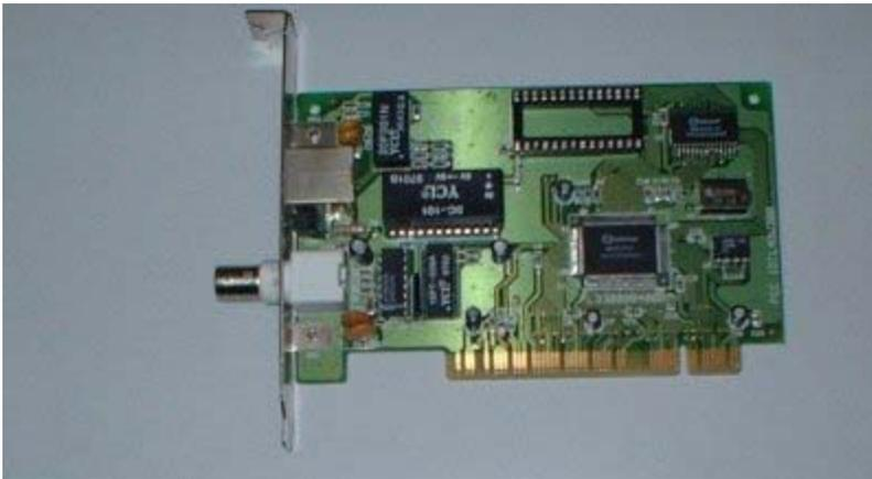
Esistono diversi tipi schede di rete in grado di gestire la comunicazione lungo i canali di trasmissione e la loro caratteristica principale è la velocità supportata.
