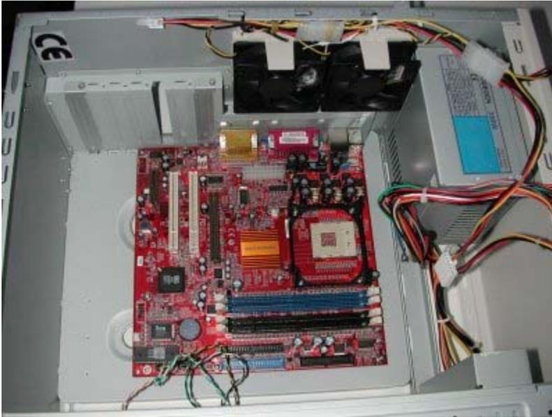
Si installa la CPU (*Central Processing Unit*) inserendola nello spazio predisposto e facendo attenzione allo spigolo smussato che identifica il suo corretto orientamento, si cosparge la sua superficie di pasta termoconduttiva per una migliore dissipazione di calore, e si applica l'aletta di raffreddamento.
