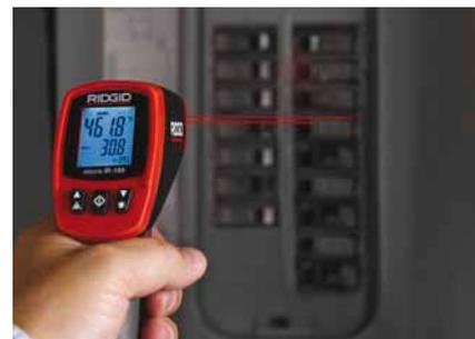
Controllo del surriscaldamento del fusibile o dell'interruttore differenziale, che potrebbe essere causato dai circuiti sovraccaricati.
