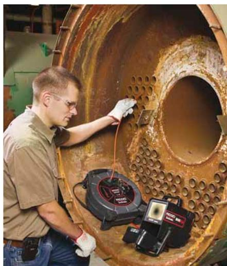
Il SeeSnake nanoReel offre nuove possibilità per le esigenze di ispezione di piccoli diametri per tratti di lunga estensione. Le applicazioni che potrebbero essere raggiunte soltanto con gli endoscopi possono ora essere ispezionate tramite il nanoReel. Boiler, Linee di rifornimento, Sistemi antincendio, ed una vasta gamma di applicazioni speciali possono tutti essere ispezionati usando il nuovo nanoReel.
