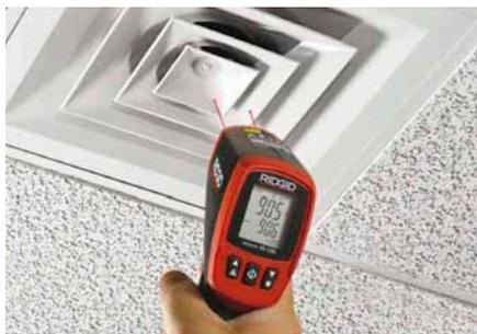
Misurazione dell'efficienza del dissipatore di calore, per rilevare e individuare le perdite termiche nei sistemi di flusso.
