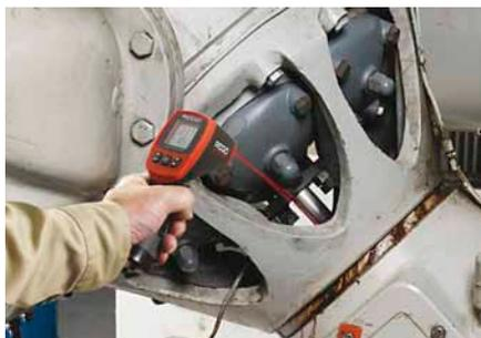
Verifica della temperatura delle parti soggette ad usura per la manutenzione preventiva dell'impianto.
