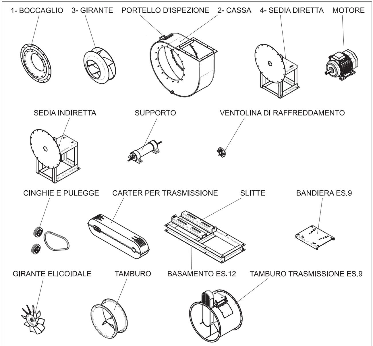
FIG. 12 (Ventilatori centrifughi)
