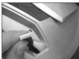
3) Inserire il connettore a 8 poli tra polistirolo e calotta fino a fare uscire il cavo dalla fessura presente nella stessa. Collegare il dispositivo bluetooth e alloggiarlo nella sua sede.
