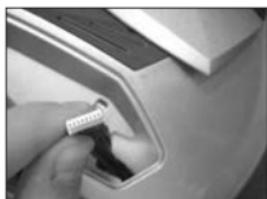
3) Passer le connecteur à 8 pôles entre le polystyrène et la calotte. Faire sortir le câble par la fente qu'il y a dans la calotte. Connecter le système Bluetooth® et le fixer dans son logement.
