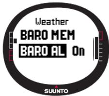
Se attivato, l'allarme tempo informa in caso di una diminuzione della pressione atmosferica superiore a 4 hPa/0,118 inHg in 3 ore.
