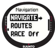
**NOTARE:** Quando si naviga in direzione di un unico waypoint, l'apparecchio non passa automaticamente al waypoint successivo. Questa operazione va effettuata manualmente. In navigazione normale di una rotta, l'apparecchio passa automaticamente al waypoint successivo quando l'imbarcazione entra nel raggio di 50 metri dal waypoint o quando si passa ad una distanza superiore ai cento metri della linea perpendicolare alla rotta (che passa attraverso al waypoint).
