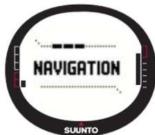
L'indicatore del rilevamento si sposta in un arco a 120° nella parte superiore del display. In caso la direzione dell'unità devii ulteriormente rispetto al rilevamento individuato, l'unità indica la direzione di svolta mediante le frecce. E' possibile seguire nuovamente il rilevamento con precisione, quando compare un cerchio sulla parte superiore del display.
