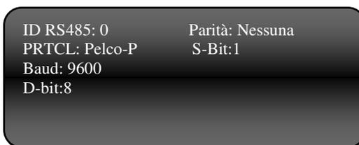
Impostare i corretti parametri di comunicazione RS485 in accordo con i parametri impostati direttamente sulle Speed Dome HRSD serie 300 Fare riferimento al manuale delle Speed Dome per maggiori informazioni.
