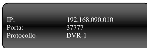
Impostare l'indirizzo IP del DVR che si vuole controllare e la porta di comunicazione che è stata abilitata in fase di installazione del DVR. Fare riferimento al manuale del DVR per maggiori informazioni. Selezionare il protocollo DVR-1 per il corretto funzionamento dei DVR serie HR.
