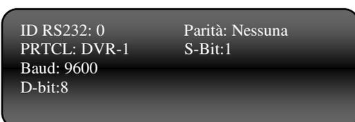
Impostare i corretti parametri di comunicazione seriale in accordo con i parametri impostati direttamente sul DVR HR pre-installato. Verificare nel menù RS-232 che siano impostati come nella figura sottostante.
