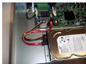
6. Connettere i cavi di alimentazione e di comunicazione dati tra il disco fisso e la scheda
