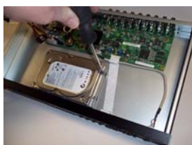
5. Rimontare la piastra con il disco fisso riavvitando le apposite 4 viti
