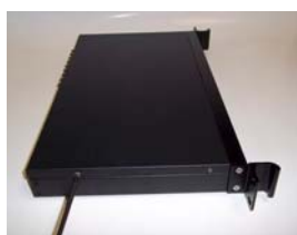
1. Svitare le viti laterali del coperchio
