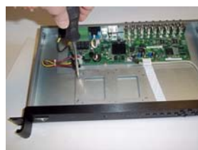
3. Svitare le quattro viti dal supporto del disco fisso
